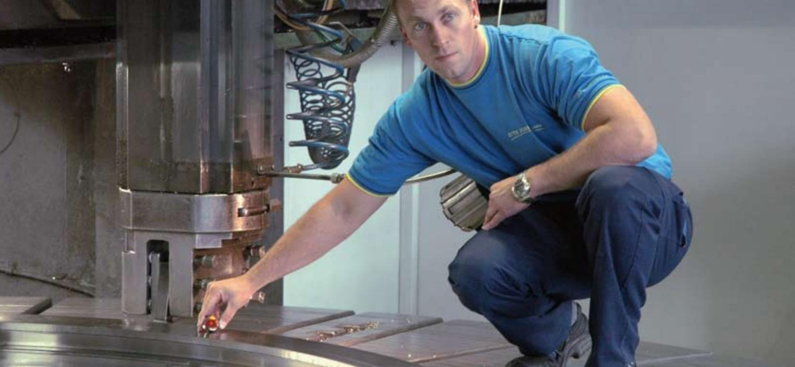
Medición directa en el torno vertical: Michael Gerards, maestro de taller para mecánica de precisión, comprueba con el reflector cerca de 30 puntos en la pieza de fundición
